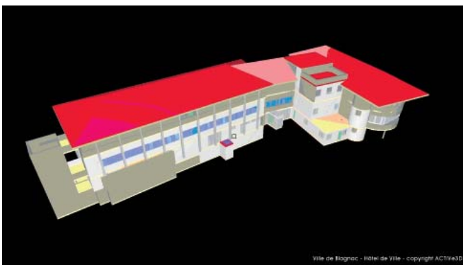
Vue d'un bâtiment de la ville de Blagnac : numérisation de l'existant en BIM-IFC.
